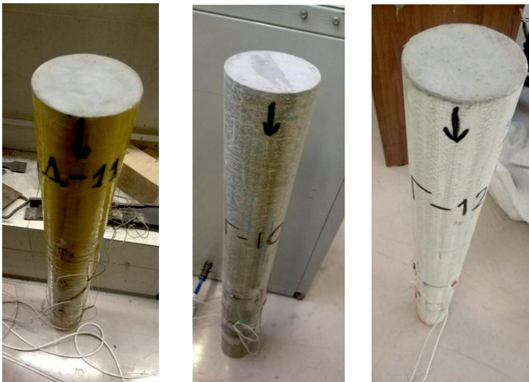
Рис. 1. Образцы для испытания гибридных стеклопластико-трубобетонных стоек с оболочками разных марок стеклопластика (слева направо): КТ-18, СО-40, СА-20
