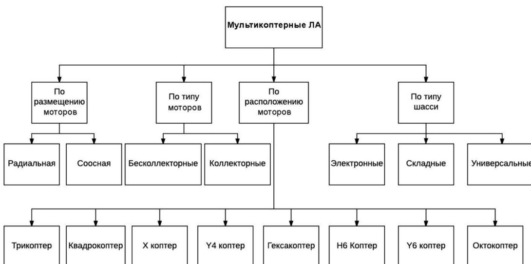
Рис. 2. Классификация мультикоптерных ЛА
