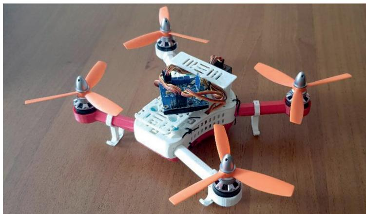
Рис. 4. 3D модель мультикоптерной платформы после печати на 3D принтере MakerBot
