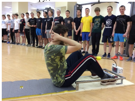
Рисунок 1 – Техническое устройство для тестирования упражнения "подъем туловища из положения лежа"
